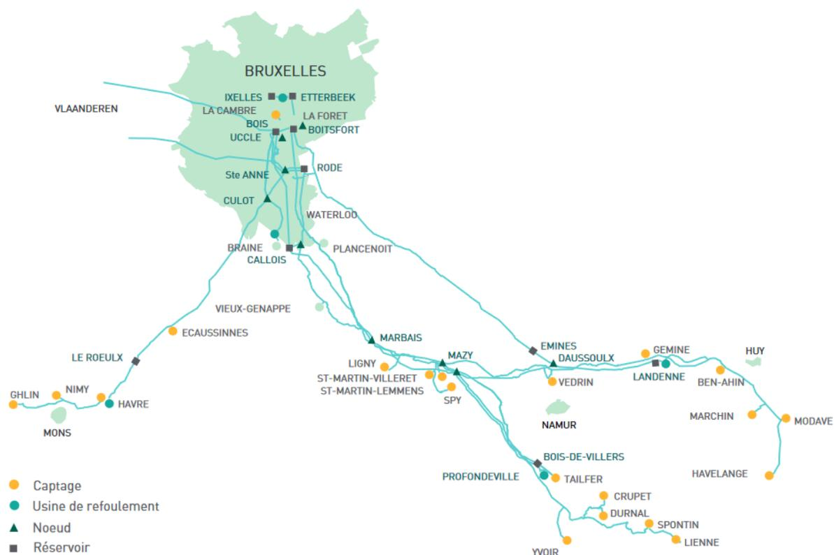
Figure 53. Activités de production, stockage et transport d'eau potable de VIVAQUA (VIVAQUA, 2020b).
